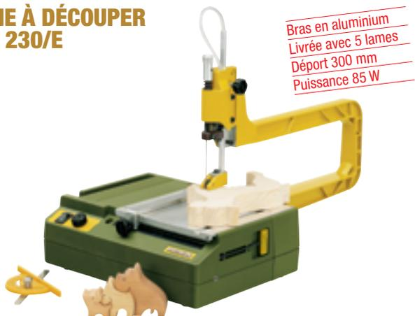
**L'appareil idéal pour le travail de précision en modélisme, construction de jouets et mécanique de précision.**
