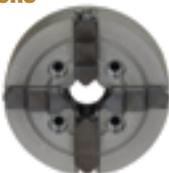
Mandrin 4-mors avec les mâchoires indépendantes pour les pièces angulaires et asymétriquement. Ø 75mm. Serrage jusqu'à 80mm
