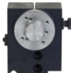
Pour l'usinage précis des pièces circulaires et la fabrication de pignons. Livré avec deux disques de division (40 et 48 dents) pour des divisions 2 ou 3 - 4 - 5 - 6 - 8 - 10 - 12 - 16 - 20 - 24 - 40 et 48. La conicité est identique à celle de la broche du tour PD 250/E. Avec fixation horizontale (par ex le chariot) et verticale (par ex le banc). Y compris les écrous et les vis assortis pour la fixation dans les rainures T standard de MICROMOT (12 x 6 x 5mm).
