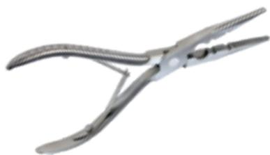
Cette pince aux longs becs (55mm) vous assurera plusieurs fonctions : pince coupante, tenue des pièces avec ses embouts dentés, ainsi que deux emplacements ronds pour tenir les fils métalliques sans les écraser (2 et 2,5mm).
