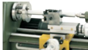
Pour un tournage longitudinal extrêmement précis. Livré avec 2 contre-pointes fixes (CM2 / CM3), 1 plateau d'entraînement avec alésage 30 mm et 2 réductions 30/20 mm et 30/15 mm. En outre 1 pivot d'entraînement fileté pour fixation sur le côté de la broche principale d'une part et un tube rallongé et le toc d'entraînement d'autre part pour le tournage.
