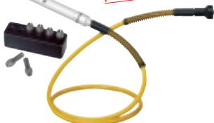
Arbre flexible en acier poli, avec double roulement à billes et logement pour pinces de serrage en acier MICROMOT. Extrémité de la tige, côté machine, montée sur roulement à billes. Extrêmement flexible (pas de surchauffe même pour les angles très fermés). Pinces : 1 - 1,5 - 2 - 2,4 - 3 - 3,2.
