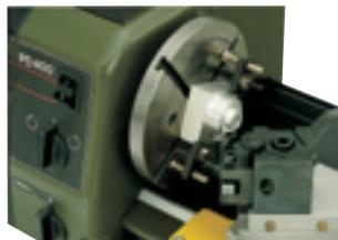
Se monte à la place du mandrin. Idéal pour le serrage de pièces de grande taille asymétriques.  $\varnothing$  125 mm. Traversé par 2 rainures continues en T. Brides de serrage comprises.
