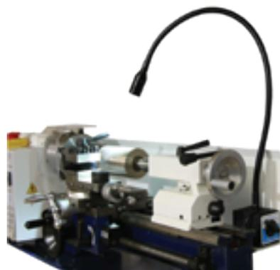
Lampe flexible à led utilisable sur tout type de machine : perceuse, tour, scie, touret etc. Cette lampe à LED surpuissante est de couleur blanche et orientable en tous sens grâce à son flexible. Elle éclaire de façon concentrée la zone de travail. Fixation magnétique débrayable similaire à un support de comparateur à cadran.
