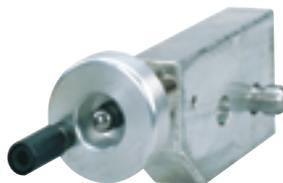
Montage en un clin d'oeil. L'avance se fait au choix en position verticale par le réglage de la hauteur ou en position oblique par l'avance fine. Avec graduation (repositionnable sur 0). Un tour correspond à 1,5 mm d'avance de broche (1 graduation = 0,05 mm).
