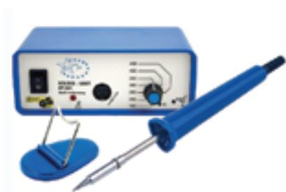
De fabrication allemande et répondant à des critères de qualité et de robustesse élevés, ce poste à souder va vous permettre tous vos travaux de soudure à l'étain. Mise en chauffe très rapide. Température réglable de 150° à 450°. Puissance de 50 W. Livré avec une panne fine. Support du fer à souder fourni. Interrupteur et voyant de mise en service. Alimentation en 230V. Dimensions : L=155 mm - H=60 mm - P=95 mm
