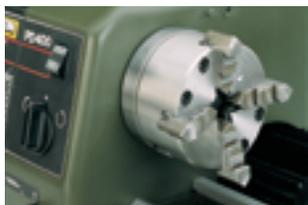
Les mors ne sont pas ajustables individuellement (serrage automatique). Grande précision de serrage. Mandrin  $\varnothing$  100 mm.
