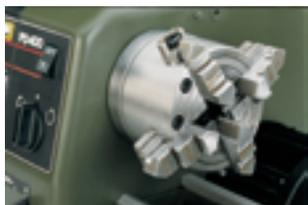
Idéal pour le serrage de pièces angulaires et asymétriques. Chaque mors se règle individuellement. Contrairement au mandrin à réglage concentrique, le centrage de la pièce se fait ici manuellement. Mors traités et réversibles. Mandrin  $\varnothing$  100 mm.
