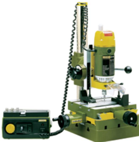
**1/ Support de perçage et de fraisage BFB 2000.** Pour perceuses standard à col de 43 mm. Réalisé avec des pièces de précision en fonte d'aluminium, pourvu de glissières fraisées en queue d'aronde. Tête inclinable jusqu'à 90°, permettant de nombreuses possibilités d'utilisation : perçage oblique, fraisage varié sans fraises spéciales et fraisage de trous obliques.
