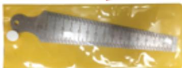
La jauge triangulaire en acier inoxydable permet de mesurer l'écartement intérieur d'un espace entre 2 éléments et de mesurer le diamètre d'un objet cylindrique. Graduation de 1mm à 15mm. Précision au 1/10.
