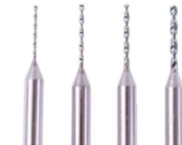
Set de forets super résistants au carbure de tungstène. Ces forets sont employés dans l'industrie électronique pour percer les platines en bakélite. Pratiquement inusables pour les emplois courants. Diam: 0.6, 0.8, 1, 1.3 mm. Queue : 3,2 mm.
