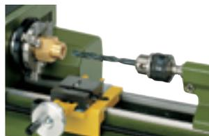
Serrage jusqu'à 10 mm. Avec clé à mandrin et filet CM1 pour la poupée mobile.
