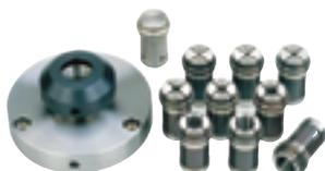
Pour le travail très précis de pièces rondes. 9 pinces de serrage trempées (1 pièce de chaque en 2,0 - 3,0 - 4,0 - 5,0 - 6,0 - 8,0 - 10 - 12 et 14 mm). Pour une concentricité de 0,02 mm, donc plus précise qu'avec un mandrin. Livré avec 1 pince de serrage non-trempée. Le dispositif de serrage est à monter à la place du mandrin. Livré dans un coffret en bois.
