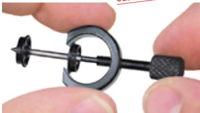
Extracteur de roues, moyeux, engrenage, etc... Outil indispensable dans la trousse à outils du bon mécanicien.
