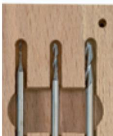
Avec deux rainures hélicoïdales et coupe en queue de poisson (coupant jusqu'au centre). Pour la pénétration dans des pièces non percées. Pour le travail de la fonte grise, la fonte malléable, l'acier, la fonte d'acier, le laiton, l'aluminium et le verre, mais aussi pour matières souples comme le plastique et la fibre de carbone. Une pièce de chaque en 1,0 - 2,0 et 3,0 mm.
