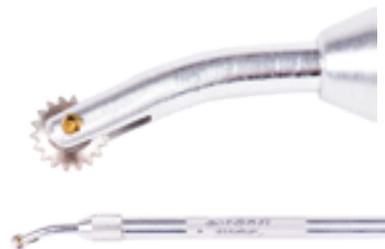
Outil très pratique donnant un résultat très réaliste. Roulez la molette pour simuler les rivets sur des bandes de cuivre, de laiton ou d'aluminium.
