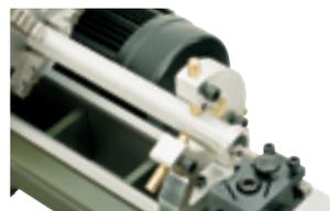
Lunette pour le PD 400. Avec adaptation pour fixation sur les glissières du banc. Pour le travail de pièces longues et surtout pour l'alésage, lorsque la poupée mobile ne peut pas « retenir » la pièce. Pour  $\varnothing$  50 mm max.
