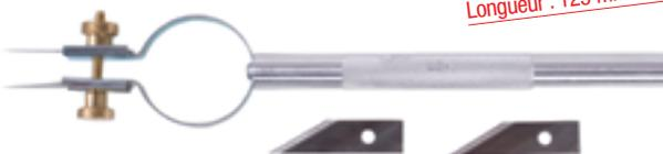
Idéal pour des coupes parallèles de papier, d'adhésif, de masquage. Découpage des cercles en utilisant l'une des lames comme pivot central. Largeur de coupe réglable de 1 à 16 mm. Manche alu de 125 mm et lames en acier. Livré avec 2 lames de recharge.
