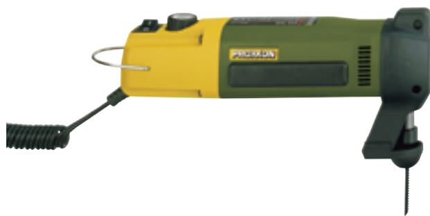
Idéale pour découpes ondulées dans le bois (10 mm max), les platines (3 mm max) et le métal non ferreux (2,5 mm max). Moteur spécial DC puissant, silencieux et durable. Réglage progressif du régime à effet feedback (puissance élevée à bas régime). Boîtier en POLYAMIDE renforcé de fibre de verre. Livrée avec 2 lames (grosse et fine) et désormais aussi avec un adaptateur sphérique pour traiter des surfaces convexes et concaves.
