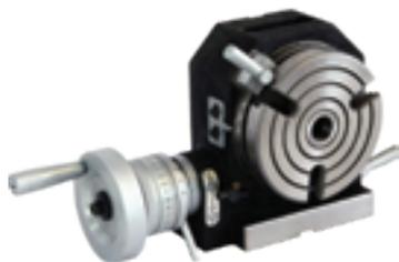
Plateau rotatif ultra-compact utilisable en position verticale ou horizontale. Très faible hauteur pour un encombrement minimal de la table machine. Plateau rectifié avec précision. Table rotative graduée sur 360°. Rapport de division de 1/72. Cône Morse CM2. Diamètre plateau : 100 mm, Hauteur centre : 81.5 mm. Graduation de la table : 360°, Largeur encoche de fixation : 12 mm, Largeur rainure : 12 mm, Fonte, Poids : 11 kg, Type : horizontal et vertical
