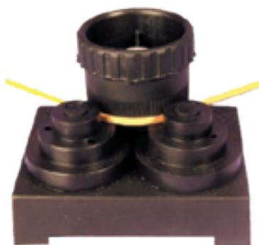
Pour cintrer toutes les baguettes de bois sans difficulté. Il vous suffit d'humidifier les baguettes à l'eau savonneuse tiède puis de les passer entre les molettes de l'outil. Les molettes sont réglables en fonction de l'épaisseur.
