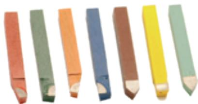
Ils sont munis d'une plaquette en carbure brasée sur un corps en acier doux de 6\*6 mm, et de longueur 50 mm. Le jeu est constitué de : un outil pelle, un couteau gauche, un outil à charioter gauche, un outil à fileter à 60°, un outil à charioter droit, un couteau droit et un outil de finition.
