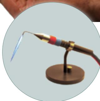
Le chalumeau est extrêmement maniable et s'utilise comme un crayon, il offre une qualité parfaite des soudures. Le chalumeau est muni de tuyaux souples de 2 mm de diamètre intérieur, équipé de clapet anti-retour de sécurité, et peut se raccorder sur un tuyau standard de 6 mm de diamètre intérieur. Le réglage se fait par 2 bagues sous la tête du chalumeau.
