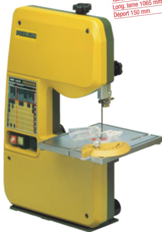
Boîtier massif en fonte d'aluminium nervurée (construction ni en tubes d'acier, ni en tôles embouties). Poulies en aluminium à double roulement. Table stable avec plan de travail fraisé à plat, rainure pour coupes d'onglet. Guide de bande monté sur 3 roulements et hauteur réglable. Réglage possible pour lames de différentes largeurs.
