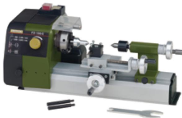
Pour le tournage plan, le tournage longitudinal, le tournage conique, alésage, perçage et taraudage. Livré avec mandrin 3 mors et pointe de centrage.
