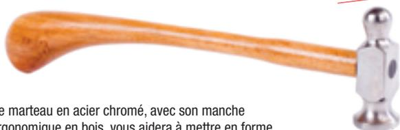
Ce marteau en acier chromé, avec son manche ergonomique en bois, vous aidera à mettre en forme vos tôles de laiton, acier doux, etc... Il comprend une partie plane cylindrique de 25 mm pour le planage des tôles et une tête ronde de 18 mm pour le profilage.
