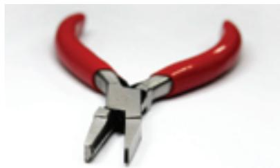
Avec cette pince dont les mâchoires ont une forme demi-ronde vous allez pouvoir façonner plats et ronds en anneaux, boucles, en "S", "C", et bien d'autres suivant l'orientation que vous donnerez aux mâchoires. Vous pouvez façonner des plats jusqu'à 1 mm d'épaisseur et les ronds de 5 mm de diamètre. Elle est en acier poli et l'articulation en "cage" assure un alignement parfait des mâchoires.
